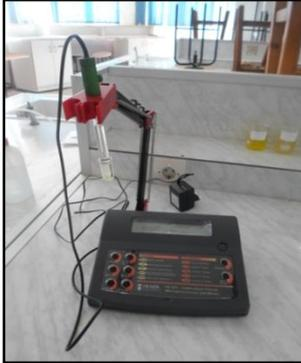
**Figure38 : PH mètre**
