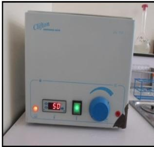
**Figure 34:** Bain marie
