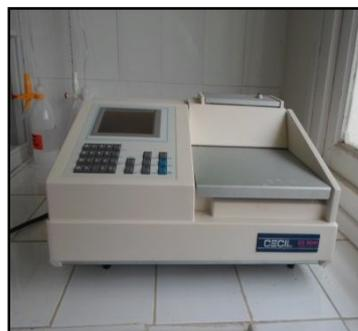
**Figure40** : Spectrophotomètre mono-faisceau CECIL
