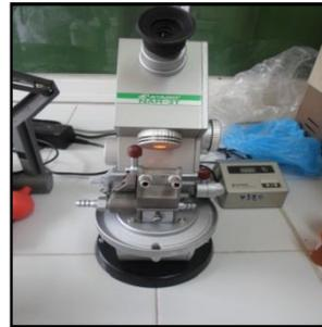
**Figure35 :** Refractomètre de type ATAGO<sup>®</sup>**Mode opératoire :**
