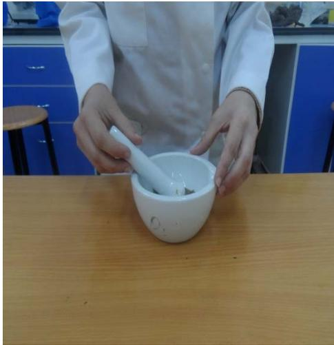
Homogénéiser les matières fécales à l'aide d'un mortier.
