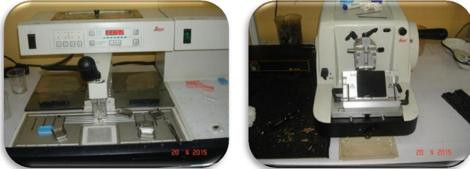
**Figure 26 :** Distributeur de paraffine et microtome (Original, 2015).
