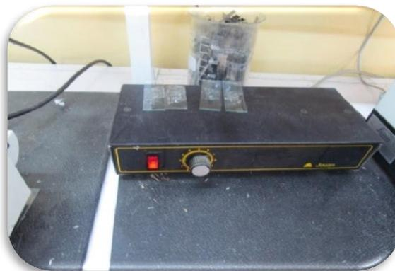
**Figure 35 :** Séchage des coupes sur la platine chauffante (original 2015)
