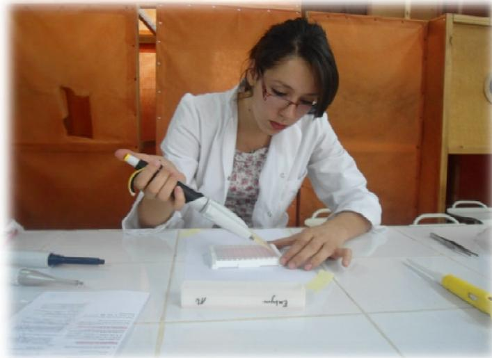
Figure 39 : Lavage de la plaque par dépôt de la solution de lavage
