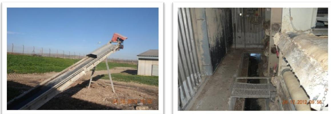
**Figure 15:Evacuation des fientes (tapis de raclages) dans le batiment « C » (Photo personnelle).**
