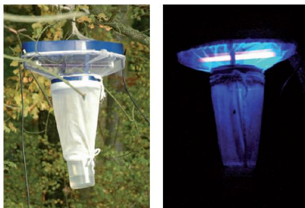
Figure 30 : piège utilisé pour la surveillance des culicoides .A droite, pièges en fonctionnement la nuit
