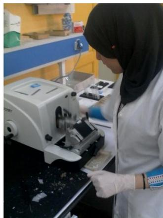
**Photo 06:** Appareil à microtomie ou Microtome    **Photo 07:** Réalisation des microtomies
