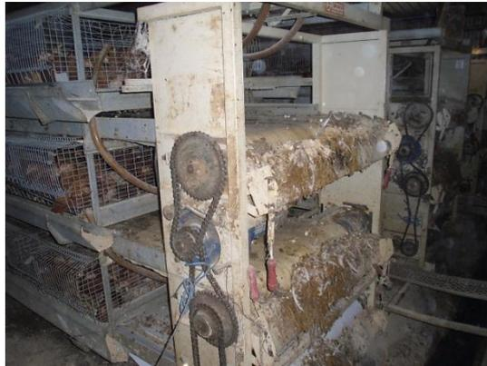
**Photo 1 :** Système d'évacuation des fientes dans l'élevage 1.
