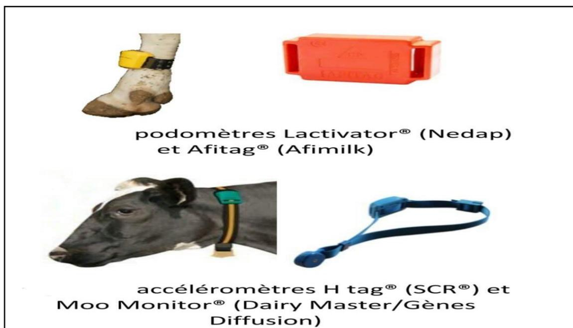
**Figure 4** : Deux exemples des outils de détection des chaleurs
