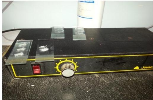
**Figure26** : Séchage des coupes sur la platine chauffante (**original 2015**).
