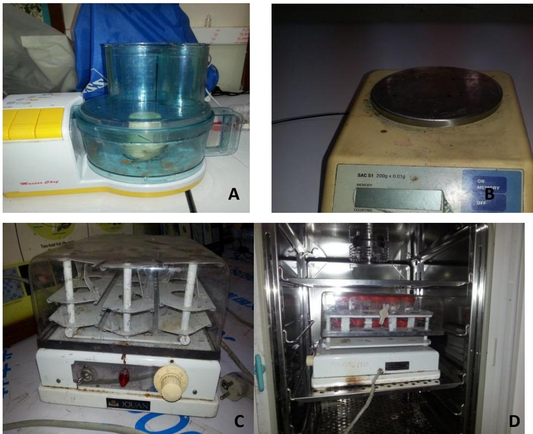
**Figure 13 :** (A) Broyeur électrique, (B) balance, (C) agitateur magnétique(JOUAN), (D) Etuve à 37°C (Originales, 2015/2016)
