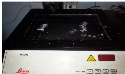
**Figure 25:** Etalement du ruban obtenu dans l'eau albumineuse (originale, 2016).
