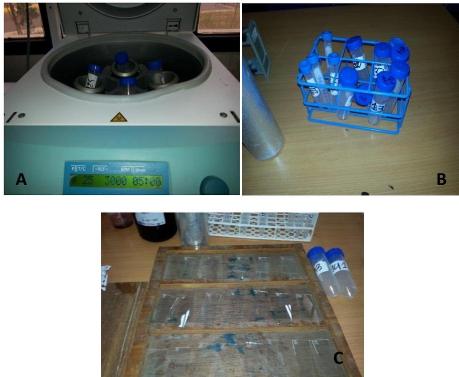
**Figure18:** (A) Centrifugation des échantillons, (B) Culots finaux, (C) préparation des lames pour l'observation microscopique
