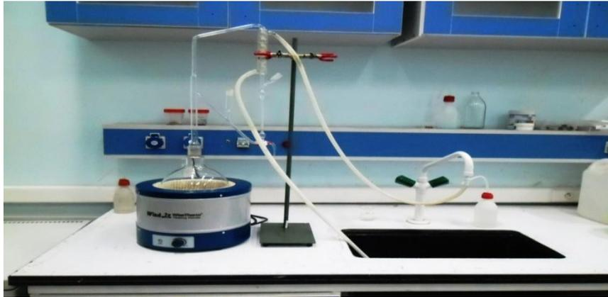
Figure 06 : Appareillage de distillation
