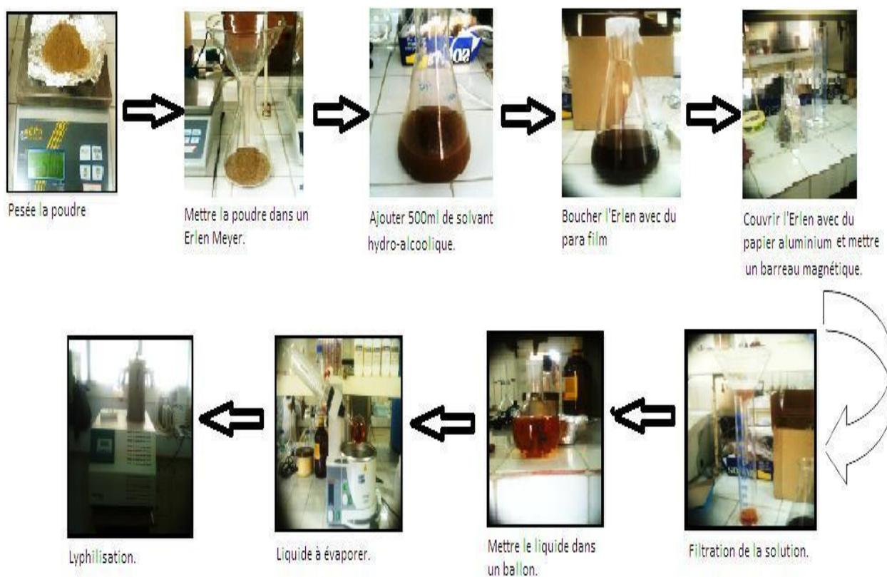
**Figure 3 :** Etapes du processus d'extraction hydro-alcoolique (photos personnelles)
