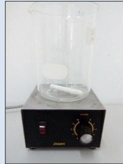
**Agitateur magnétique :** Mellow Line, MSH basic avec barreau magnétique
