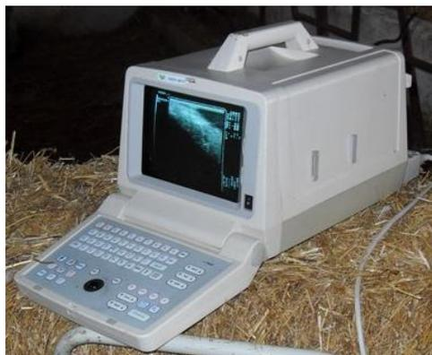
Image 1 : l'échographe utilisé dans notre étude expérimentale (CHISON 600VET®)
