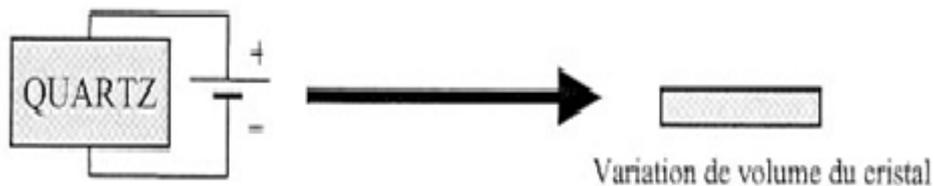
Figure2 : effet piézo-électrique inverse (TAINTURIER. B, 2001).
