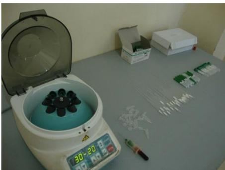
Image 4 : centrifugeuse réglée à 3000 tours par minute pendant 20 minutes
