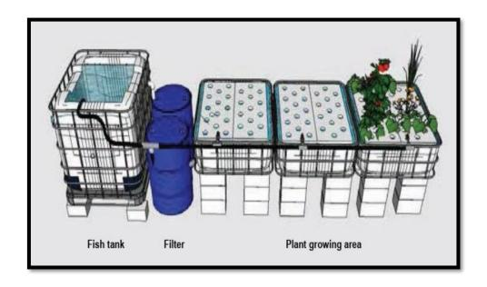
**Figure 4 :** Représentation d'une unité aquaponique constituée de culture sur raft et de Deux filtres (mécanique et biologique) (FAO, 2017)
