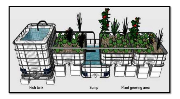
**Figure 8:** Représentation d'une unité aquaponique constituée d'un lit de culture à substrat inertes (FAO, 2017)
