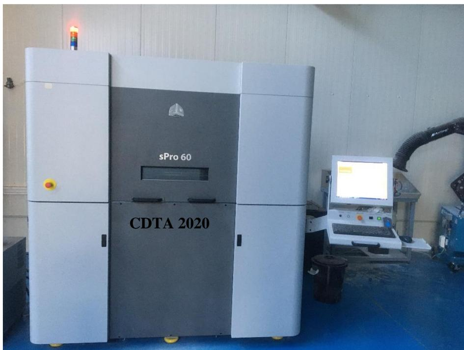
Figure 17: l'imprimante 3D SLS Spro60 HD 3DSystem (Photo personnelle. 2020. CDTA).
