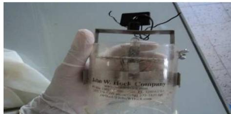
**Figure 6 : Dispositif du piège lumineux**
