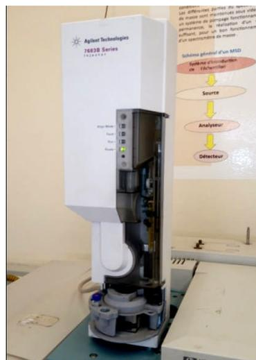
**Figure 8 :** Echantillons d'acides gras en phase d'analyse GC-MS par autosampler
