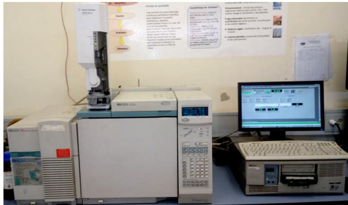
**Figure 7 :** Chromatographe en phase gazeuse (Agilent GC., modèle 6890) couplé au spectromètre de masse (Agilent GC-MS., modèle 5973)
