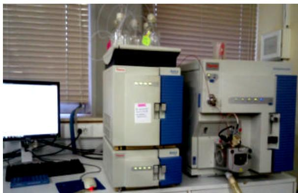
**Figure 11** : Instrument LC-MS/MS avec ses compartiments
