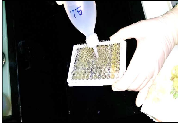
Photo 8 : rinçage des puits.
