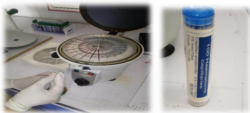
**Figure 5 :** Centrifugeuse à hématocrite et les tubes capillaires
