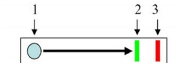
Figure 07 : Schéma représentant le principe de l'immunochromatographie (Jex *et al.*, 2008).
