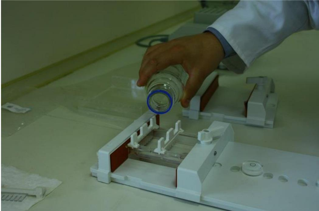
Figure 9 : Coulage de solution d'agarose dans le plateau
