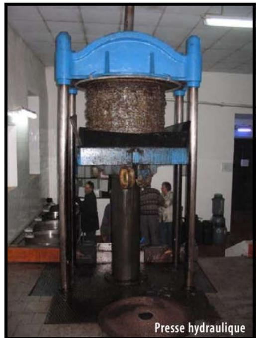
Figure 2 : Système de presse hydraulique pour l'extraction de l'huile (Chimi, 2006)
