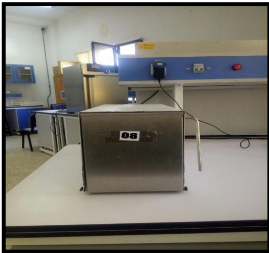
Image a. Broyeur type Stomacher
