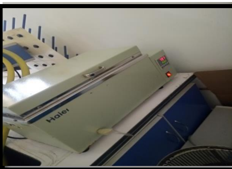
Chauffage de la suspension mère à 80°C dans un bain-marie
