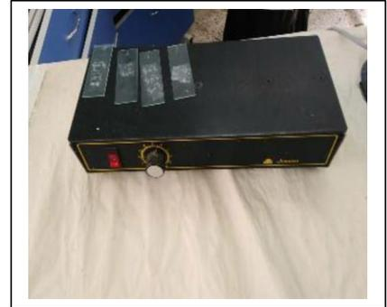
**Figure 36:** Séchage des lames (Photo personnelle).
