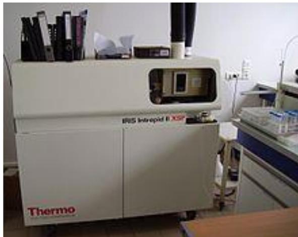
Figure 14 : spectromètre ICP-AES. (Cjp, 2009)
