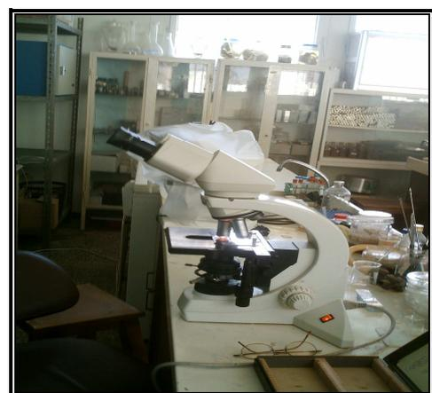
**Figure 34 :** Microscope optique (Originale, 2006).
