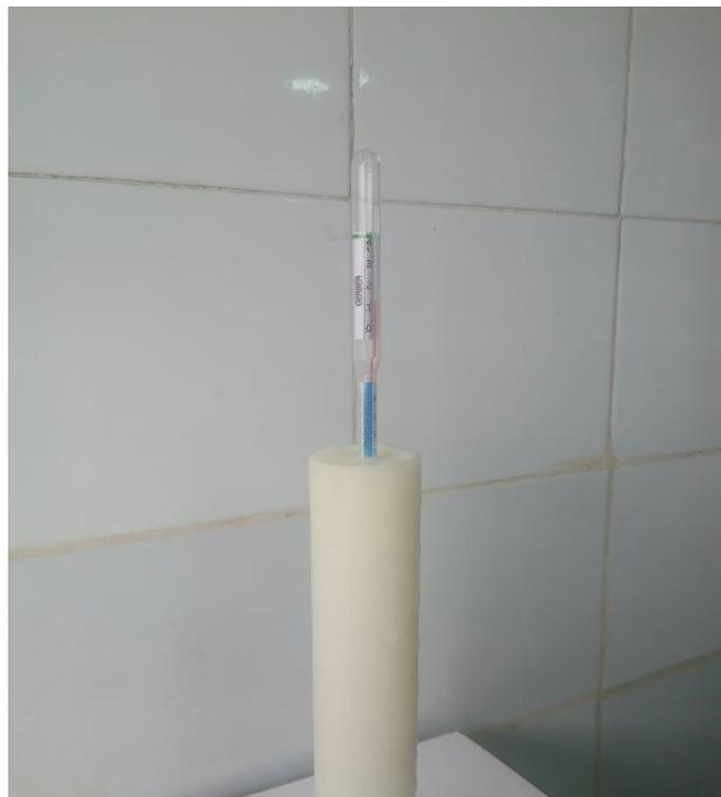
**Figure N 01:** Mesure de la densité par thermo-lacto-densimètre (photo personnelle).
