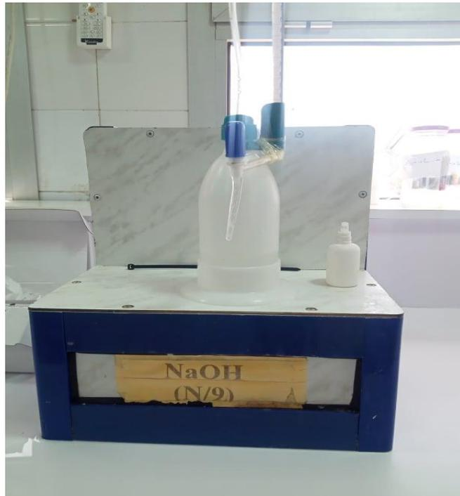
**Figure N° 02:** Mesure de l'acidité titrable (photo personnelle).
