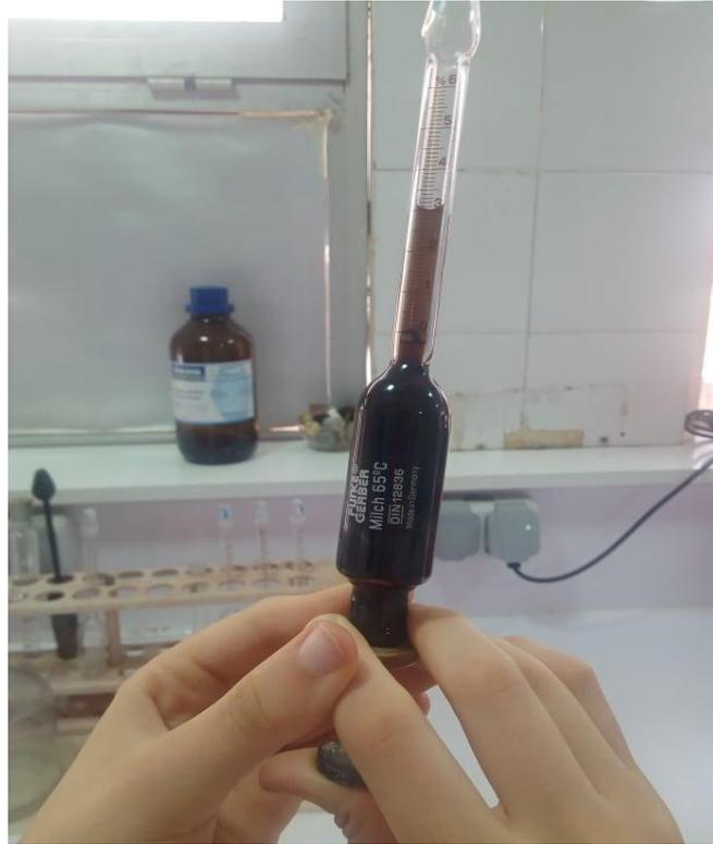
**Figure N°04:** Mesure de la matière grasse par la méthode acido-butyrométrique
