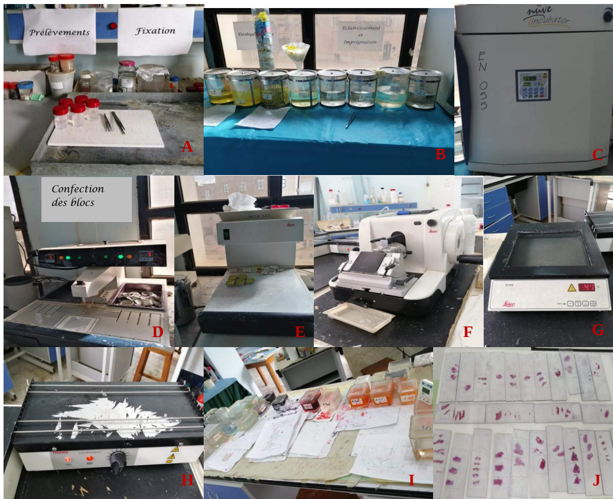
Figure 12 : Étapes de la technique histologique, prélèvement et fixation (A), déshydratation et éclaircissement (B), imprégnation (C), confection des blocs (D), plaque de refroidissement (E), microtome (F), étalement et collage (G), séchage (H), coloration (I), séchage des lames (J).
