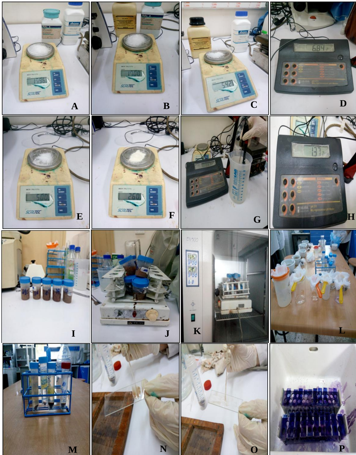
Figure 13 : Etapes de la digestion enzymatique, pesée du \text{Na}_2\text{HPO}_4 \cdot 2\text{H}_2\text{O} ( A ), pesée du \text{NaCl} (B), pesée du \text{NaH}_2\text{PO}_4 \cdot 2\text{H}_2\text{O} (C), ajustement du pH de la solution PBS (D), pesée du \text{NaCl} (E), pesée de la pepsine (F), ajustement du pH de la solution de digestion (G et H), mélange du broyat et de la solution de digestion (I), agitateur magnétique (J), incubation (K), filtration des échantillons (L), échantillons après centrifugation (M), étalement du frottis (N et O), coloration des lames au MGG (P)
