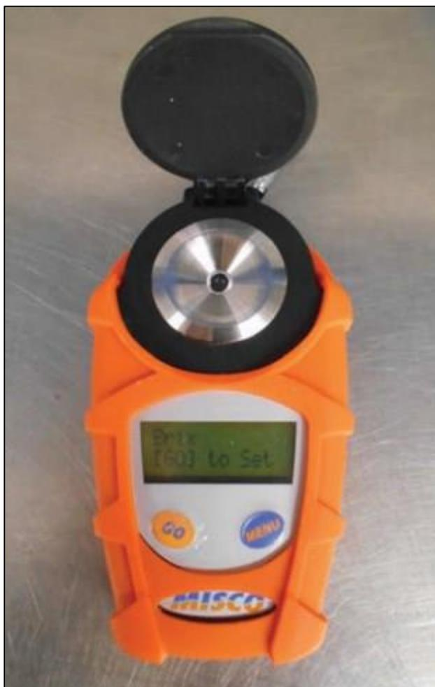
Figure 16 : Réfractomètre de Brix digital (Morin, 2018).
