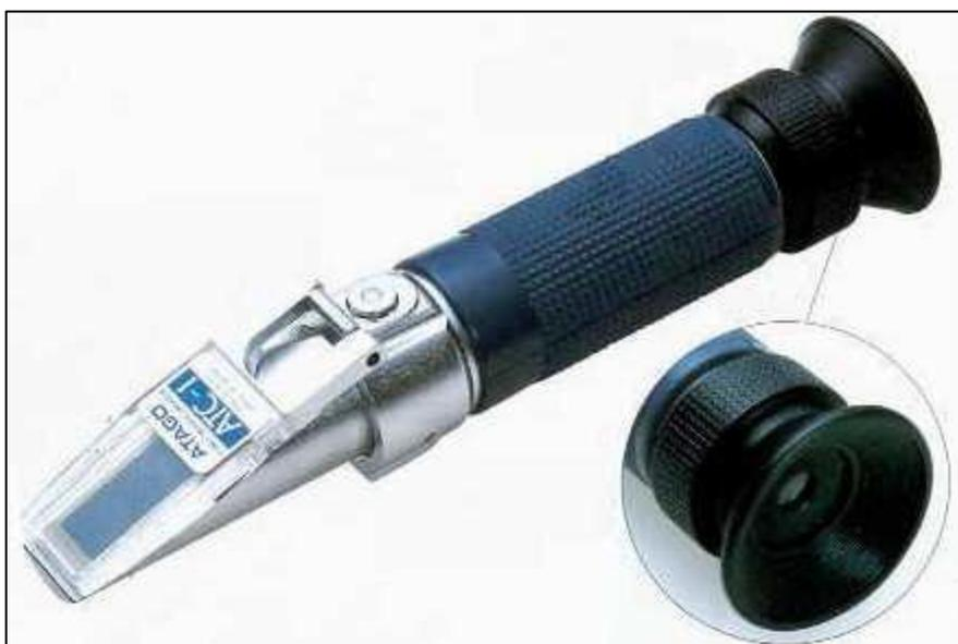
Figure 15 : réfractomètre portable « Brix » (**Imbert, 2005**).
