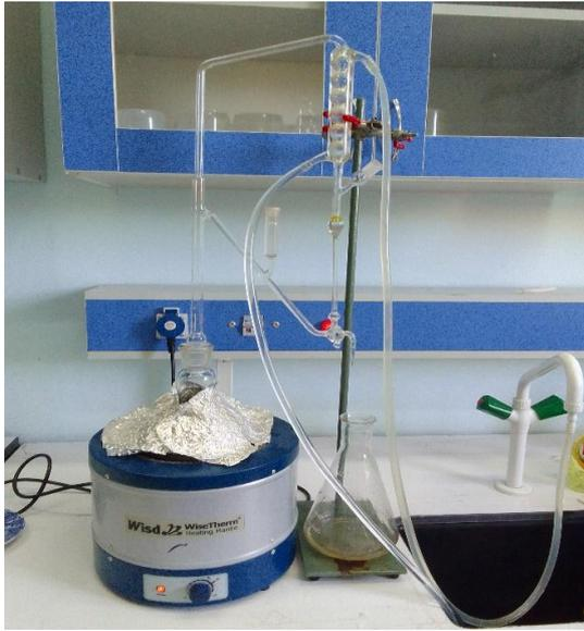
**Photo7 : Dispositif d'hydro distillation type Clevenger (photo personnelle)**
