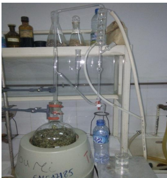
Photo 4: Dispositif d'hydrodistillation type Clevenger (Photo personnelle)
