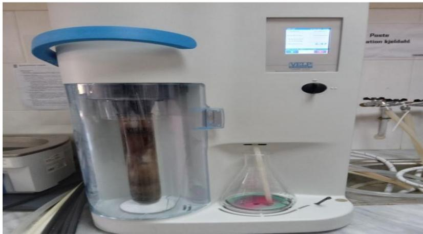
**Photo13** : Distillation kjeldahl des échantillons. (Photo personnelle,2022)
