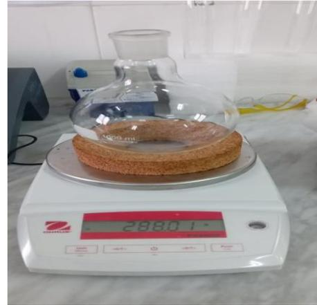
**Photo11** : Séchage et pesage du ballon pyrex après évaporation du solvant. (Photo personnelle, 2022)
