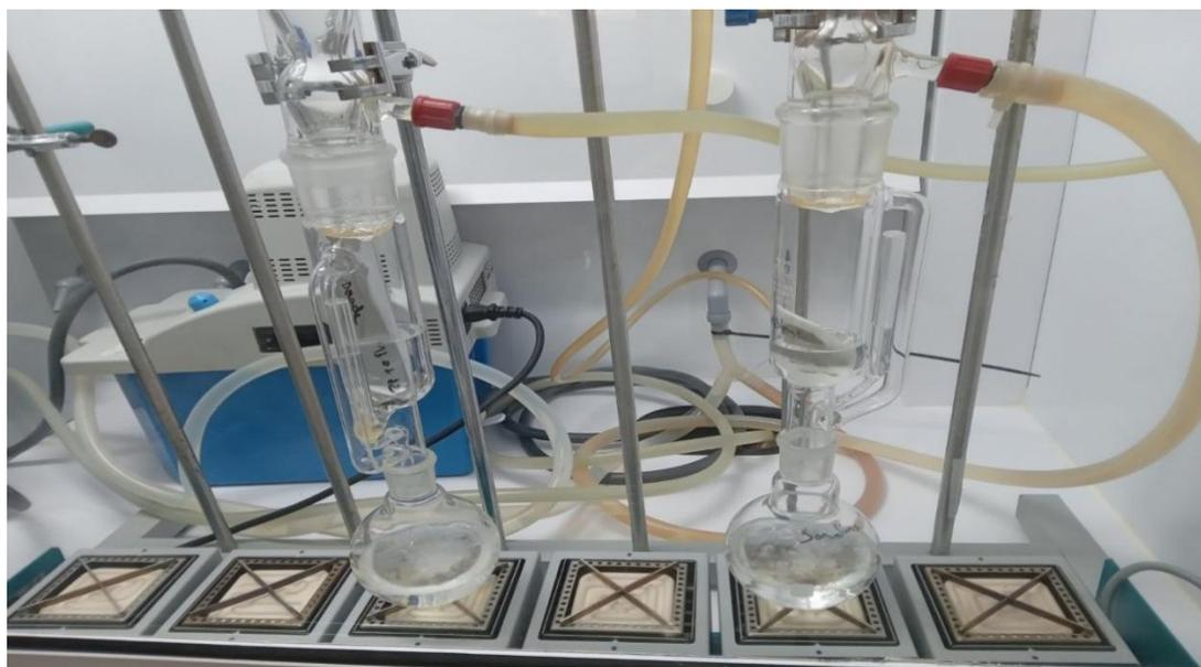
**Photo 9:** Dispositif Soxhlet pour extraction de la matière grasse totale. (Photo personnelle, 2022)
