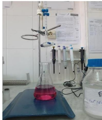
**Photo14** : Titrations des échantillons par acide chlorhydrique(HCL).(Photo personnelle,2022)
