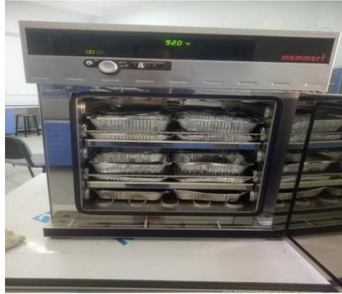
**Figure 18** : Séchage des échantillons pour les différentes analyses chimiques.
