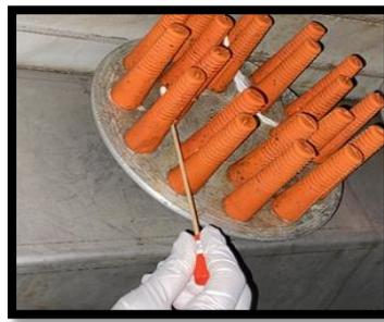
**Figure N°5.** Doigts plumeurs
