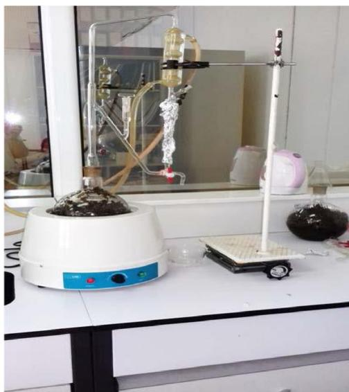
**Figure 5 : Montage de l'hydrodistillation employé pour l'extraction de l'huile essentielle**
