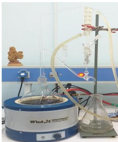
**Figure 16** : Dispositif d'extraction de l'huile essentielle (**photo originale 2024**)
