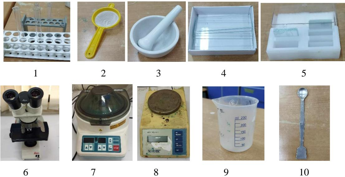
**Figure 38** : Matériel de laboratoire utile pour la méthode de flottation (photos originales, 2024)
