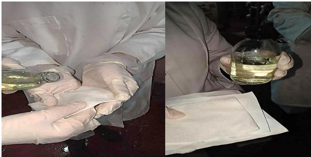
Figure 10: Compresses stériles imbibées utilisées pour le prélèvement des surfaces (photos personnelles)
