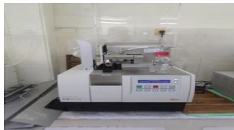
**Figure 15:** Appareil de montage et coloration
