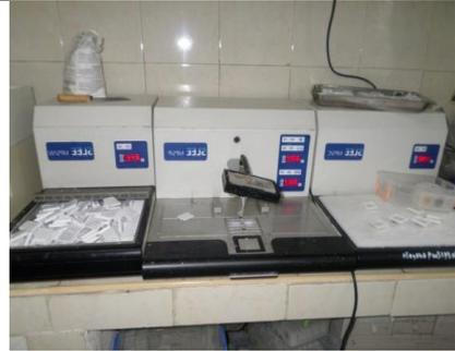
**Figure 9 :** Appareil d'enrobage
