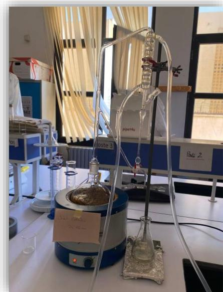
**Figure 11** : Dispositif d'hydro distillation type Clevenger (**Originale 2024**)
