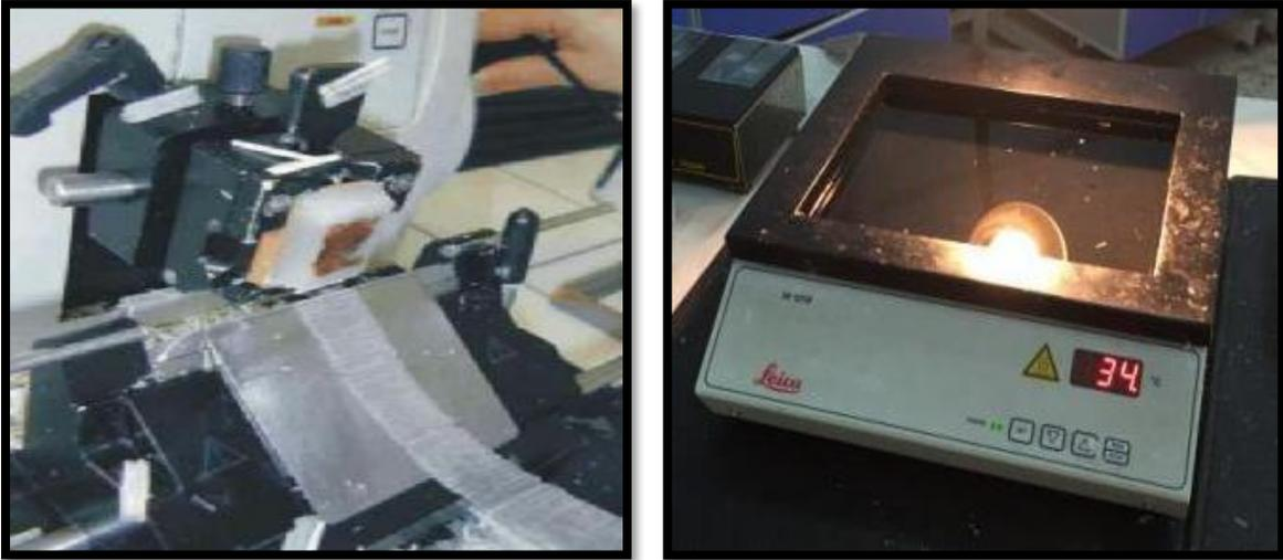
Fig. 7 : microtomie des blocs de paraffine et étalement des rubans (photo personnelle)
