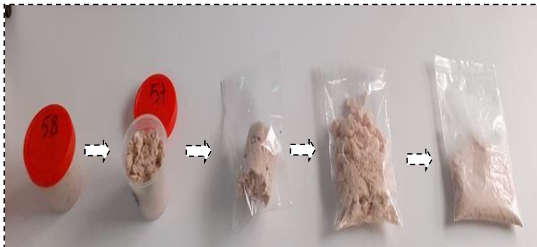
Figure 25 : Broyage et homogénéisation des lyophilisats (Photo personnelle).
