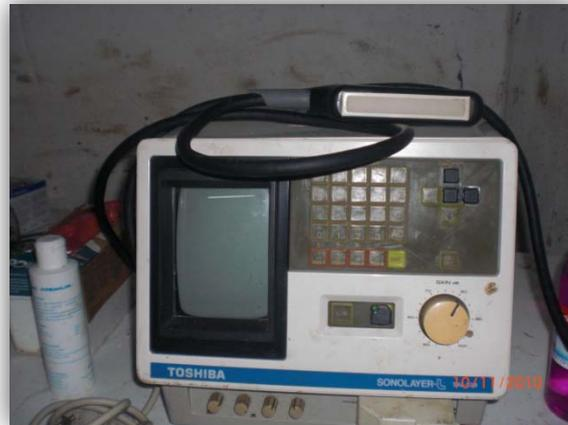
**Figure 45 : échographe utilisé lors de notre travail**
