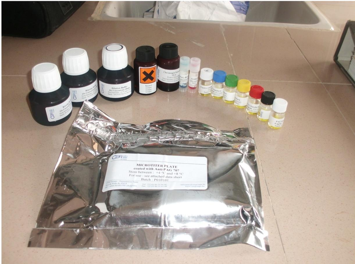
**Figure n° 6:** photo présentant les éléments composant le kit (la plaque à 96 puits, les solutions standards, les réactifs, la solution de rinçage et le tampon de dilution).
