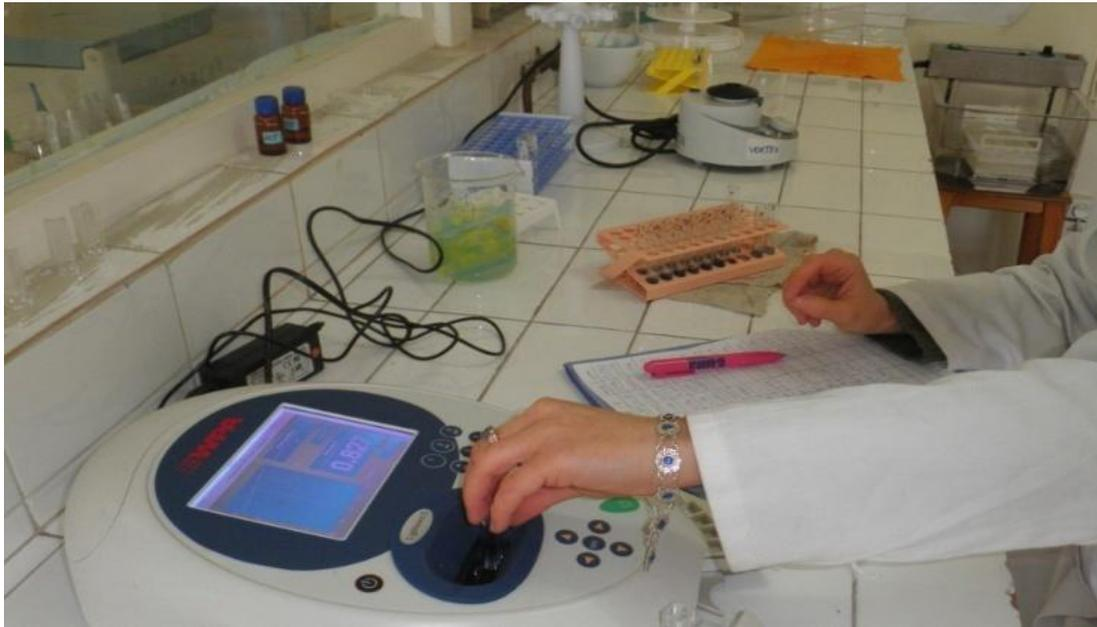
**Photo 5 : Mesure par Spectrophotométrie d'absorption moléculaire (lightwave II- WPA)**
