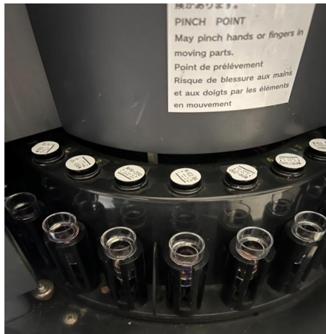
Figure66 : Compartiment d'analyse des cupules d'échantillon associées au godet de réactifs (personnelle, 2025)
