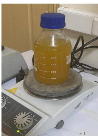
Figure 21: : Vortexage et Homogénéisation du Milieu Mueller-Hinton
