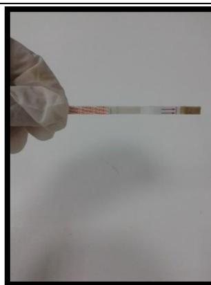
**Figure 18 :** La lecture doit se faire sur des bandelettes encore humides
