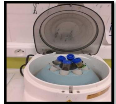
**Figure 5 :** Centrifuger : 45000 tours par 3 minutes
