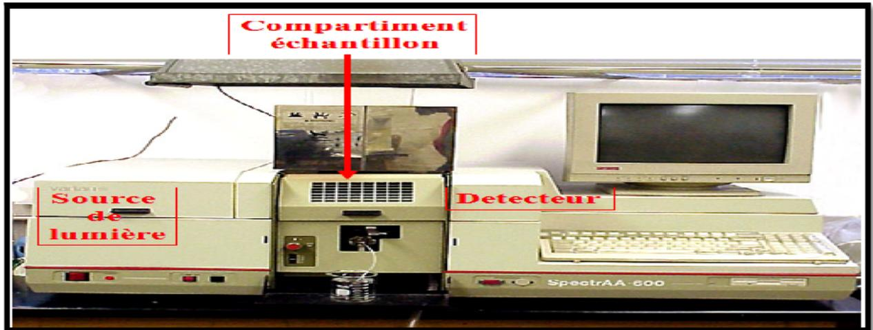
**Figure 14 : Spectromètre d'Absorption Atomique UNICAM 929**
