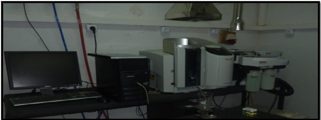
**Figure 15 : Spectromètre d'Absorption Atomique (Thermo Scientific ICE 3000)**
